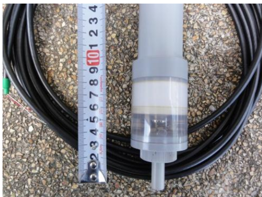
図 3-37 当該斜面で使用しているテンシオメータ
