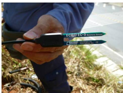
図 3-34 当該斜面に設置している土壌水分計（カードタイプ）
