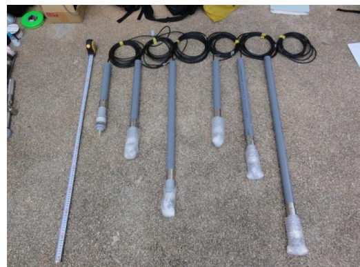
図 3-37 当該斜面で使用しているテンシオメータ
