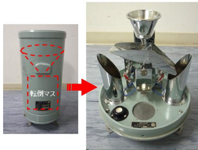
図 3-14 転倒ます型雨量計の外観および構造
