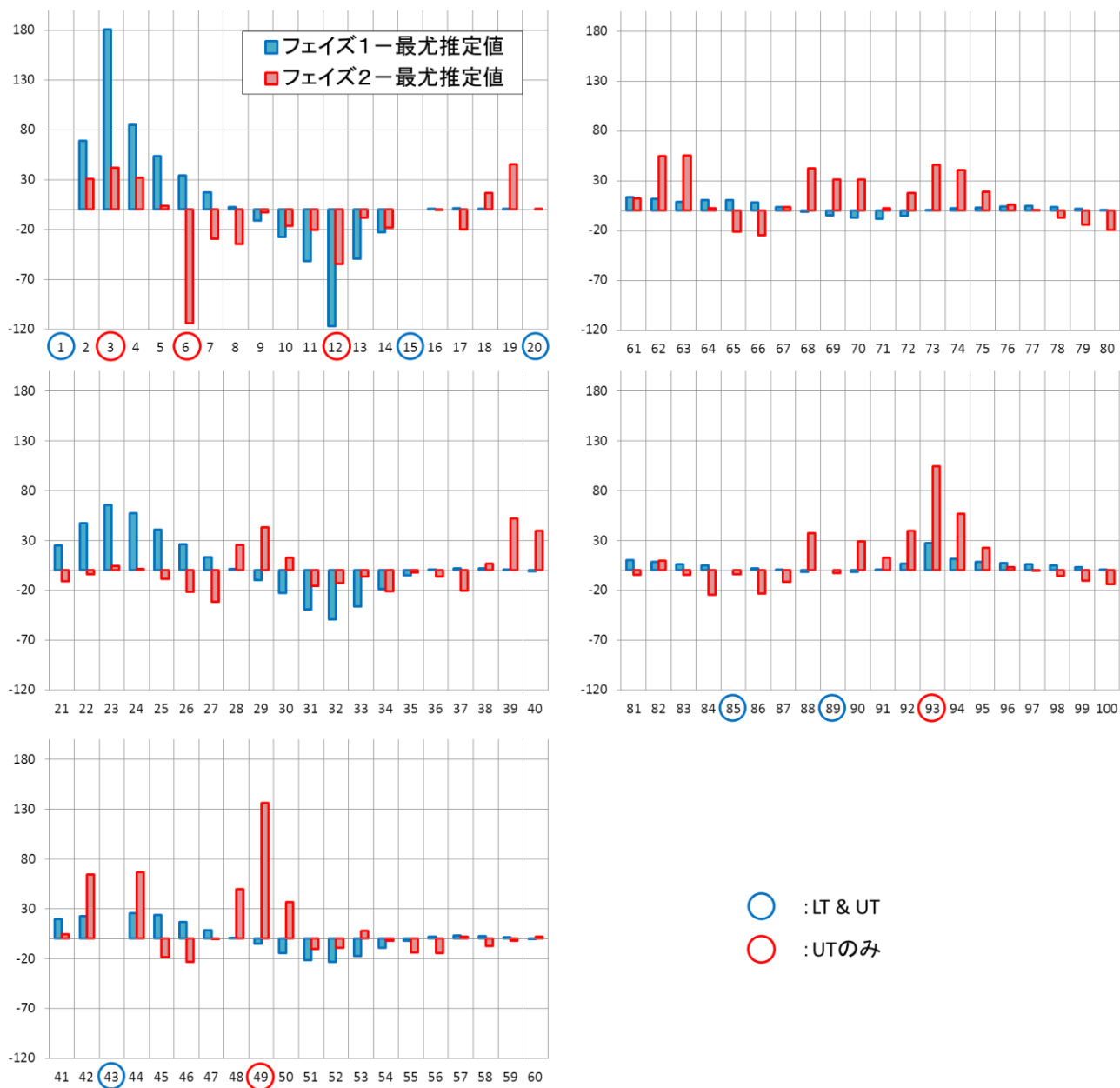
図 4-2 推定残存緊張力と最尤推定値の比較
