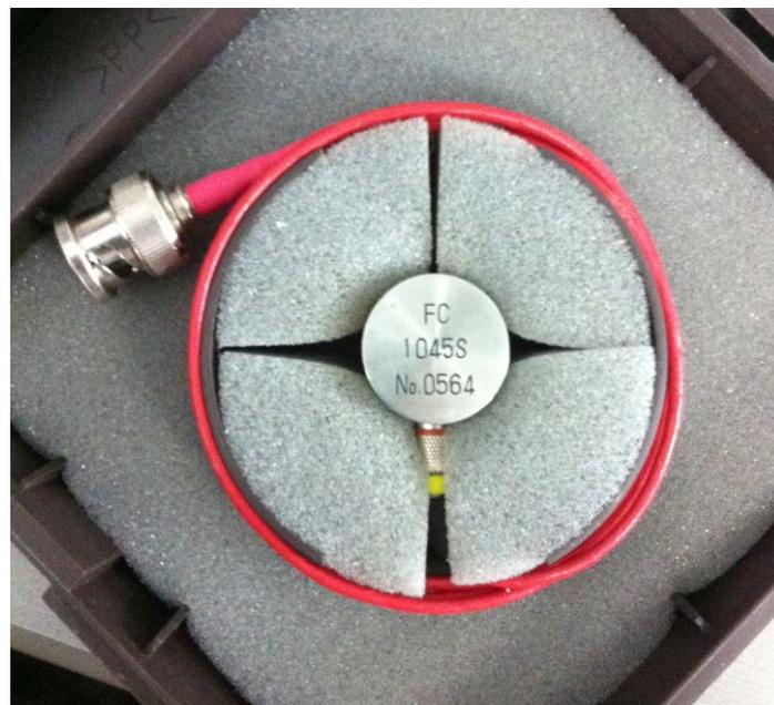
図4.2.4 1045S(広帯域型センサ、富士セラミックス社製)
