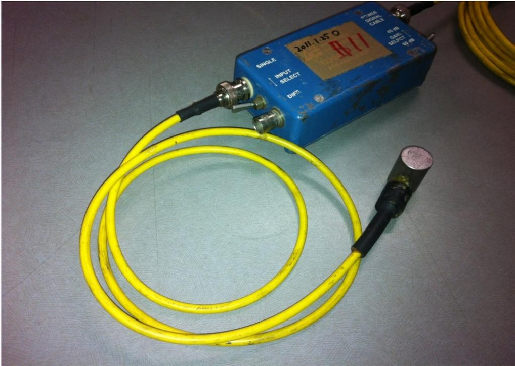
図4.2.5 60 kHz共振型センサ(富士セラミックス社製)と
