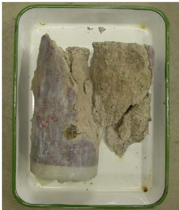
図 4.4 せん断破壊直後の供試体
